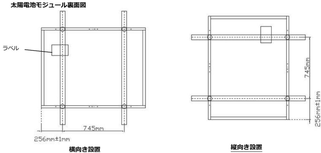
外側の穴で設置する場合 ※穴の直径 8.5 mm、ボルトは M 8 を使用し、15 N・m 以上の力でしっかりと締め付けてください。
