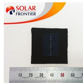
世界最高変換効率 23.35%を達成した Cd フリー
